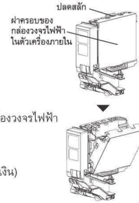
รูปที่ 1: การถอดฝาครอบออกจากกล่องวงจรไฟฟ้าในตัวเครื่องภายใน
